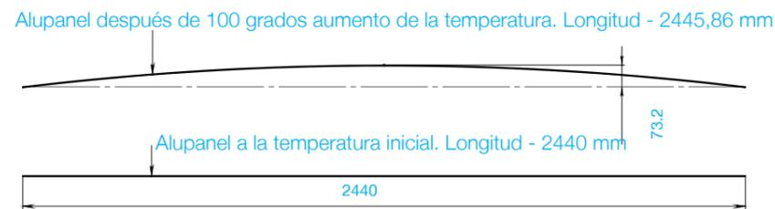
Al hacer se puede ocurrir que un sustrato en la cual se va a instalar Alupanel encima está fijado de manera rígida, sin tomar en cuenta la expansión térmica. En este caso el sustrato podría doblarse y reflexionar, ocasionando en el doblado del Alupanel también. Para prevenir esto es necesario examinar cuidadosamente a los sustratos donde se va a instalar Alupanel.
